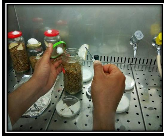
Figure 16: déposition les morceaux d'agar dans les flacons de substrat.
