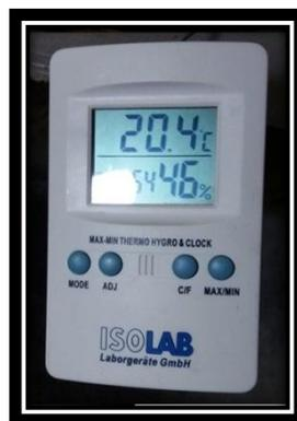
Figure 20 :Thermo-higromètre pour contrôle la température et l'humidité.
